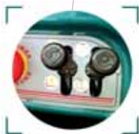
Comando a leva tramite distributore idraulico per traslazione laterale forche di 60 mm.
